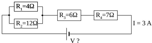
b) El voltaje de alimentación del circuito. (0,4 puntos)
